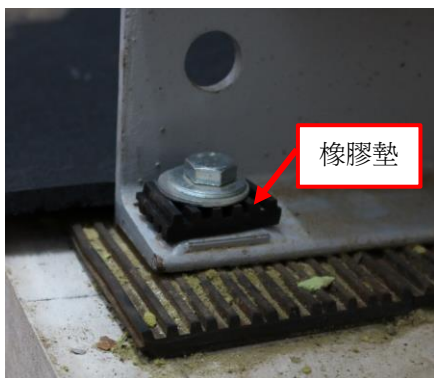
在機器和地面間安裝細小避震軟墊 (橡膠墊)
